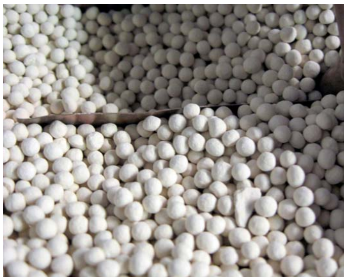
Abb. 3 · Zeolith-Kügelchen können Wasserdampf in ihren Poren binden, dabei entsteht Wärme. (Quelle: Fraunhofer IGB)
