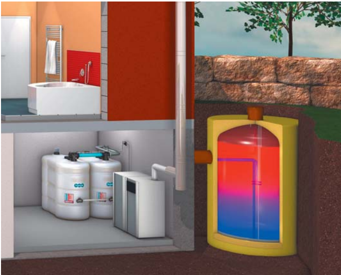
Abb. 5 · Stehender Heizungspufferspeicher mit hochwirksamer PUR-Schaum-Isolierung und zusätzlicher GFK-Außenschale für den unterirdischen Einbau. (Quelle: Dehoust GmbH)
