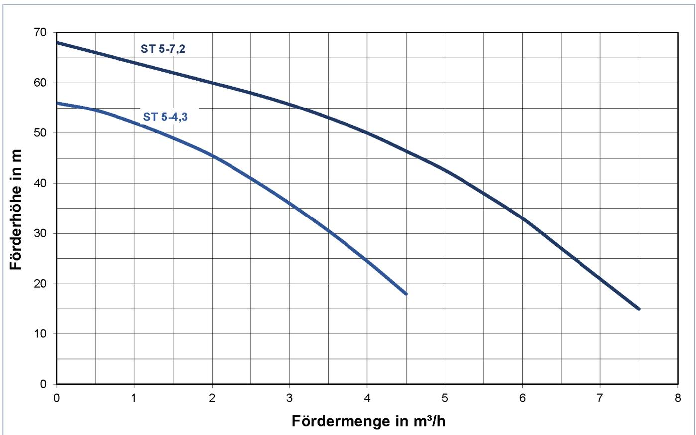
\* Diese Übersicht basiert auf einer kinematischen Viskosität von 1 mm²/s und einer Dichte von 1.000 kg/m³
