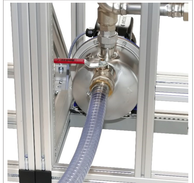
Abbildung 10: PVC-Schlauch 1 ¼ Zoll (GWtec® 140/240) und 1 ½ Zoll (GWtec® 340/440/640) mit 3-teiliger Messingverschraubung an Filtratpumpe befestigen
