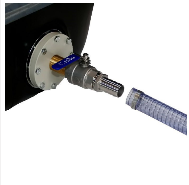
Abbildung 9: PVC-Schlauch 1 ¼ Zoll (GWtec® 140/240) und 1 ½ Zoll (GWtec® 340/440/640) mit Edelstahl-Schlauchschelle am Grauwasser-Filtrations-Tank befestigen
