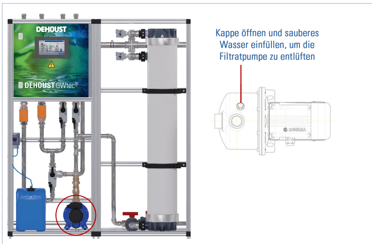
Abbildung 24: Filtratpumpenentlüftung
