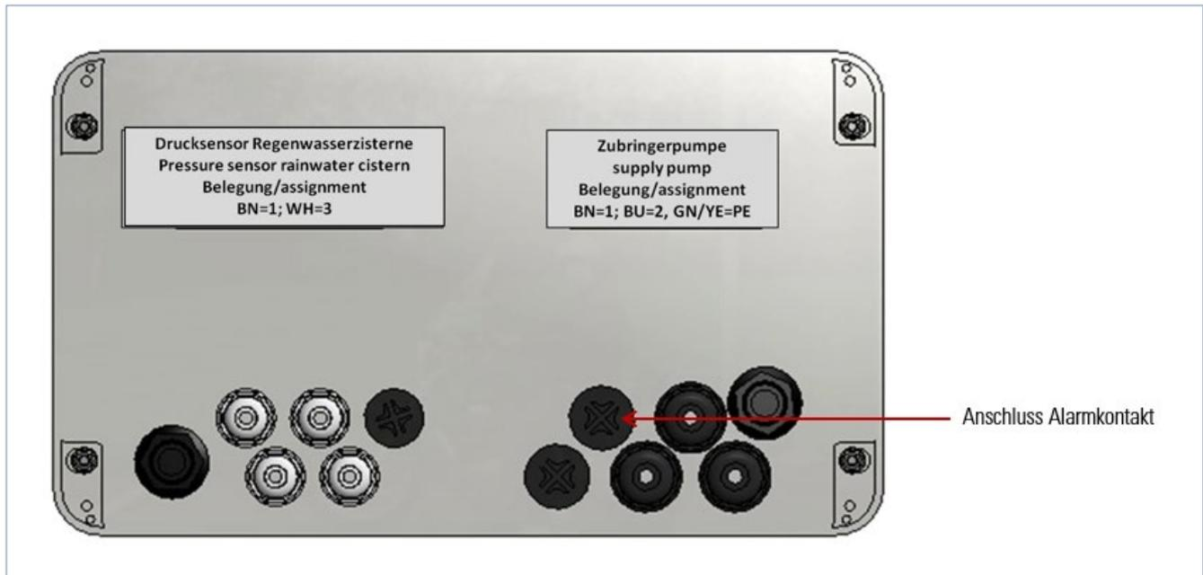
Das Anschlusskabel für den Alarmausgang durch die markierte Kabeleinführung an der *Smart Connect*-Steuerung in die Steuerung führen.
